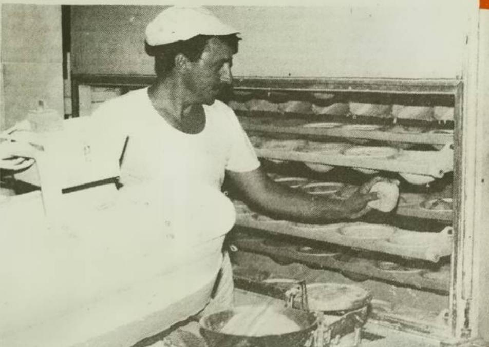
Golova tijesto oblikuje se na ovome stroju, a nakon toga na vaganje. Ona štruka -od kila- ima zapravo 70 dag. Ta ležina istaknuta je na svim članovnicima.
